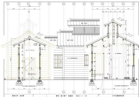
図5 実測吉田寮便所断面詳細図 13)
